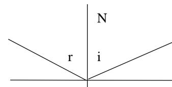
Dans la figure ci-contre,  $\hat{i}$  et  $\hat{r}$  sont respectivement les angles d'incidence et de réflexion.
