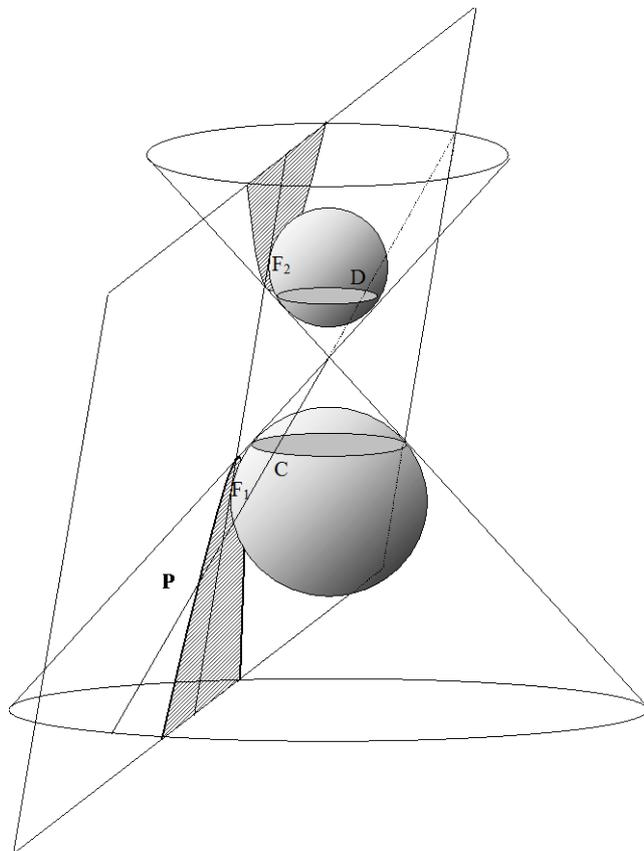
Le schéma ci-contre illustre la situation. Nous allons montrer que la section obtenue est une courbe qui vérifie la condition : "la différence des distances d'un point de la courbe à deux points fixes est une constante.
